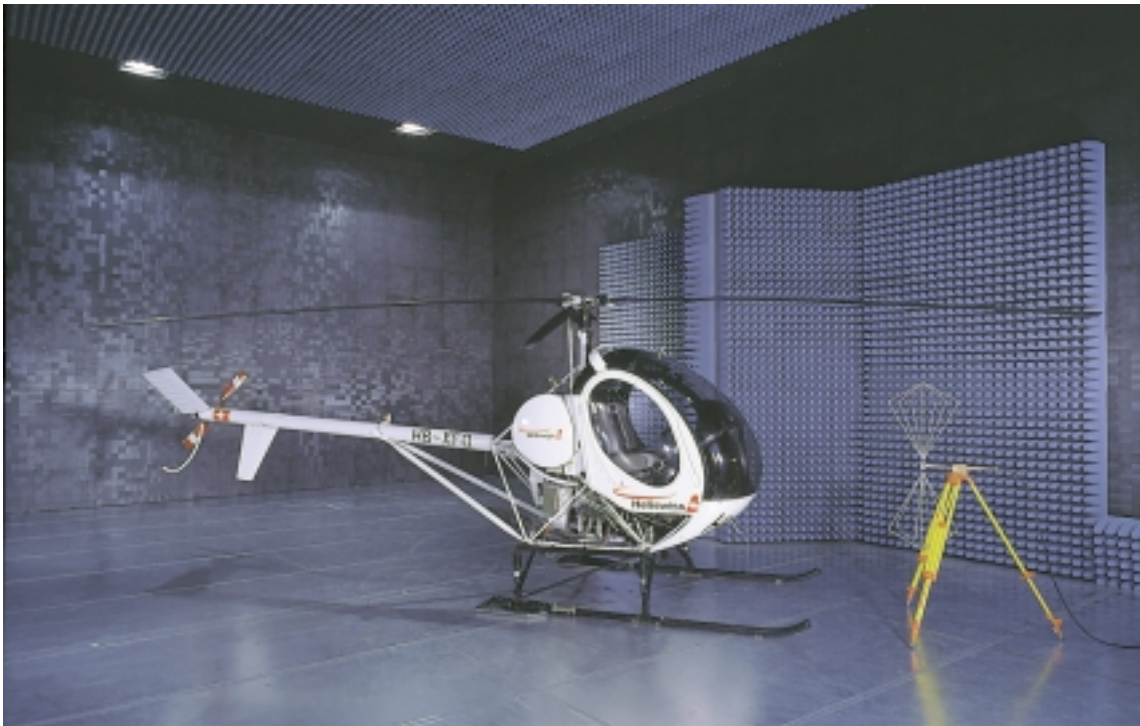
Mesure en chambre anéchoïque de 15,5x10x7 m (ferrites)
